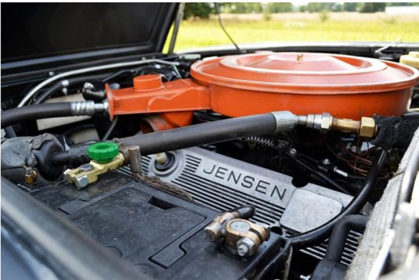
Auch der von 1971 bis 1973 gebaute „SP“, dessen Achtzylindermotor anhand von drei Doppelvergasern eine Leistung von 385 PS aus den 7,2 Litern generierte, brachte aufgrund extrem kurzfristiger Wartungsintervalle des Vergaser-Six-Packs nicht den erwünschten Durchbruch. Nur 232 Exemplare entstanden und sind heute eine entsprechende Rarität.
