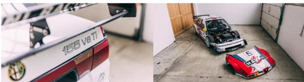
In 1996 wurde aus der DTM die International Touring Car Championship (ITC). Dieser 155 V6 TI in Martini-Farben ist die letzte Evolution des Werkstourenwagens von Alfa Corse. Der 2,5-Liter-V6-Motor leistet rund 497 PS, kann bis auf 11.900 U/min drehen und hat seine Kraft an ein halbsequentielles Sechsganggetriebe gekoppelt.
