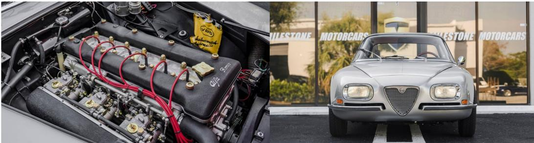
Der komplett neu aufgebaute Motor besitzt Merkmale wie hoch verdichtete Kolben, Performance-Nockenwellen und Stahlrohrkrümmer. Wir malen uns sehnsüchtig aus, wie gut dieser große italienische Klassiker klingen mag, zumal er auch noch mit den so wichtigen, seltenen und originalen Weber-Ansaugkrümmer mit drei 40 DCOE-Vergaser von Weber ausgerüstet ist.
